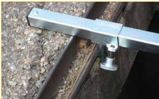
Puntoni scorrevoli e regolabili posti alle estremità dei bracci per trattenere la croce nella corretta posizione.
