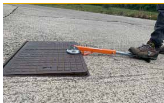
Sblocco chiusino tramite perno centrale
