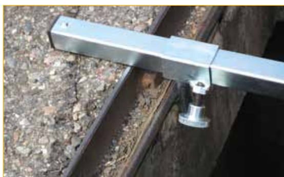
Puntoni scorrevoli e regolabili posti alle estremità dei bracci per trattenere la croce nella corretta posizione.
