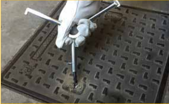
Configurazione 1 Estremità con punta elicoidale per rompere e raschiare.
