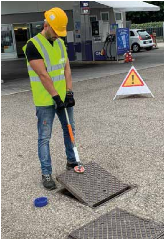
Utensili di categoria 3 ATEX adatti ad essere utilizzati in luoghi classificati ZONA 2.
