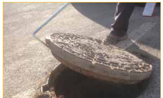
Costruito in acciaio bonificato 38NCD4 con finitura zincata antiruggine che rende LB7 un attrezzo robusto e resistente.
