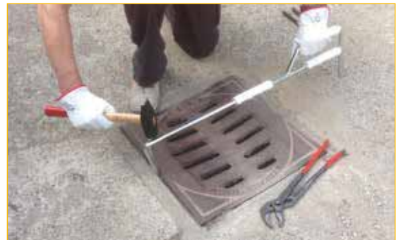
I becchi possono essere utilizzati anche nelle operazioni di raschiatura delle cavità di presa dei coperchi.
