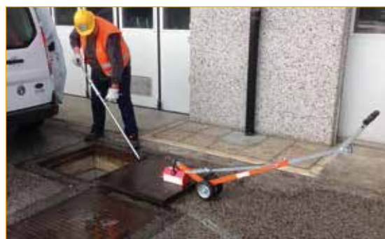
La sua forma particolare permette di sbloccare i chiavistelli antiapertura dei coperchi e, successivamente, d'essere impiegato come leva di sollevamento.
