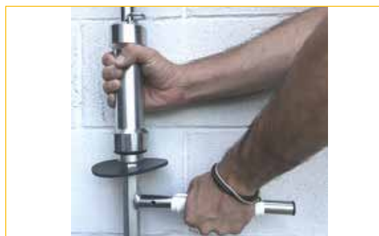
Percussore scorrevole ed impugnatura lontana dal punto di percussione.
