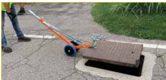
Utilizzo 3: sollevamento meccanico con morsetti di bloccaggio.
