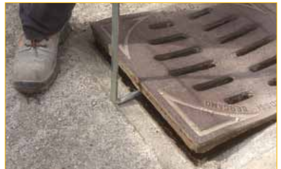
Il dorso dell' impugnatura a "D" fornisce un punto di fulcro per facilitare il leveraggio di sollevamento.
