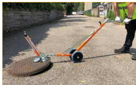
Utilizzo 2: sollevamento con leva pieghevole APS90.
